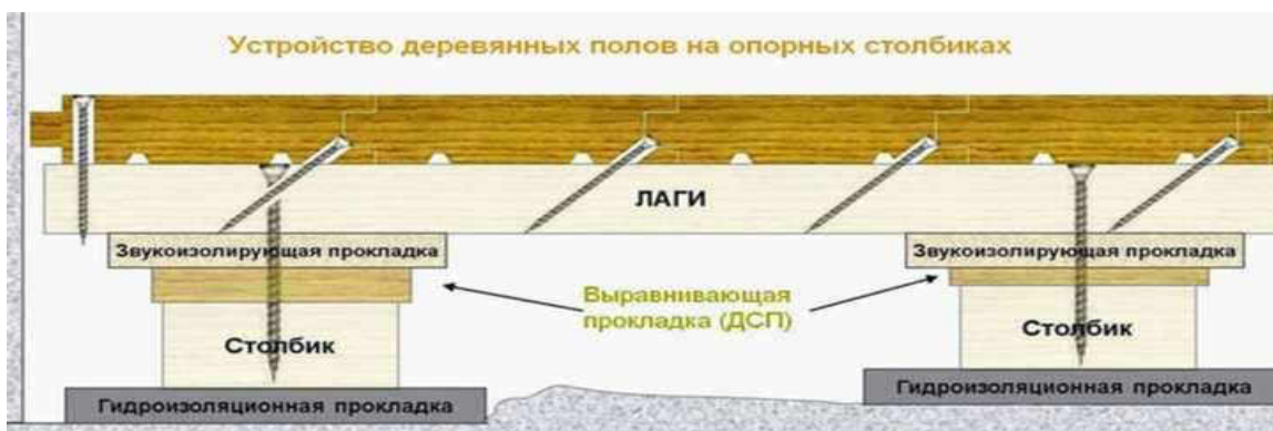
Рис. 28 Устройство деревянных полов на опорных столбах
