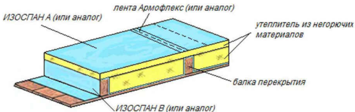
Рис. 25 Утепление деревянного перекрытия
