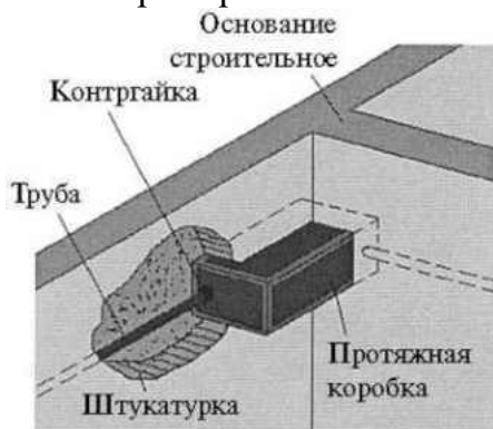
Рисунок 2. Переход скрыто проложенной трубы с одной стены на другую через протяжную коробку
