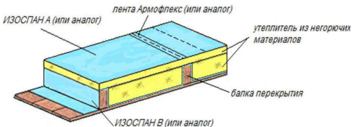
Рис. 20 Утепление деревянного перекрытия
