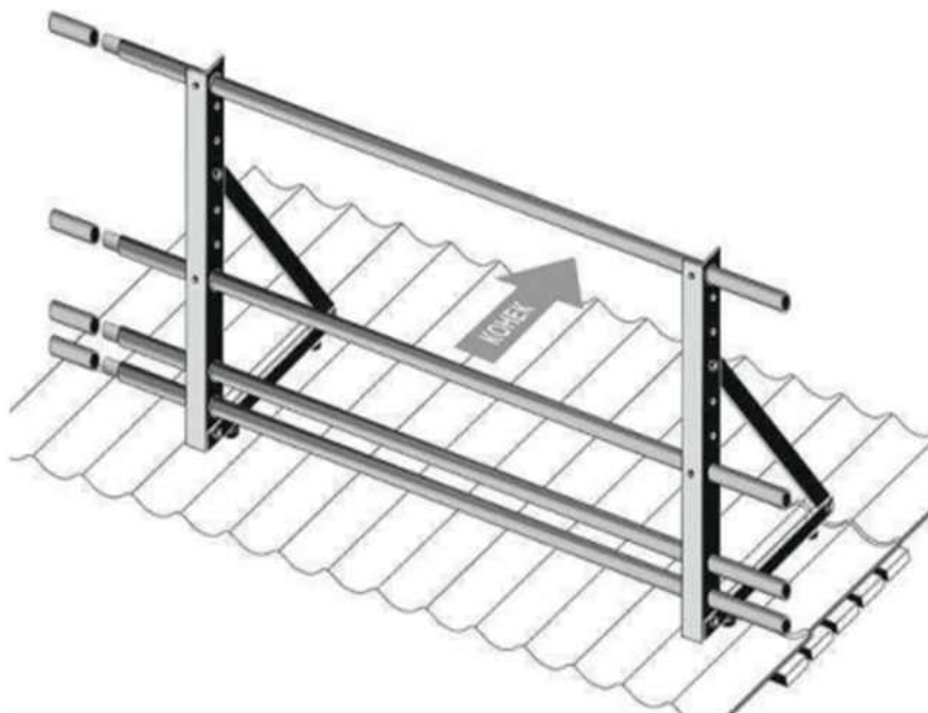
Рис. 16 Комбинированная система снегозадержание с ограждением заводского исполнения
